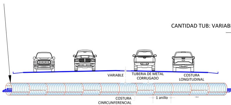
**ALCANTARILLA BAJO LA VIA PARA PASO DE TUBERÍAS DETALLE 4 CORTE A-A ESC 1-100**
